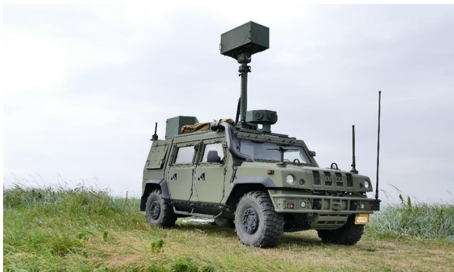
Obr. 5: Mobilní pasivní průzkumný ELINT prostředek – SRTP.
