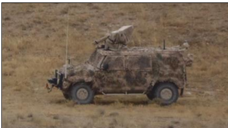
Obr. 8: Příklad mobilního maskování pro vozidlo LOV IVECO.
