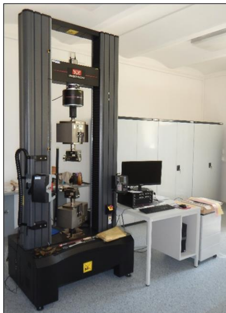
Obr. 25: Elektromechanický univerzální zkušební stroj pro zkoušky tahem.
