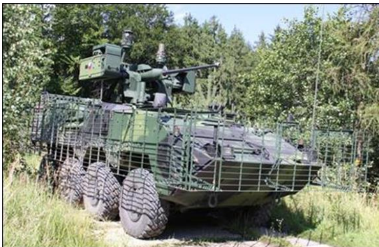
Obr. 10: Příkladový pancíř a mřížová ochrana „SLAT“ na vozidle Pandur II.
