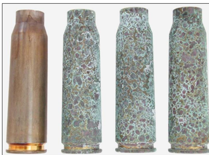
Obr. 24: Vzorky nábojnic po vystavení koroznímu prostředí komory se solnou mlhou (vlevo nábojnice před zkouškou).
