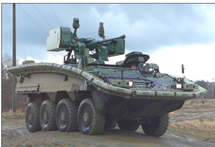
Obr. 12: KBVP Pandur II 8x8 M1 CZ s prototypem systému Pokročilá aktivní balistická ochrana.
