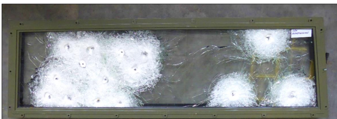
Obr. 9: Pancéřové okno po střeleckých zkouškách.
