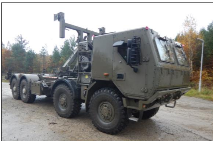
Obr. 11: Prototyp soupravy dodatečného pancéřování OCHRATECH K I na vozidle Tatra T815-7.
