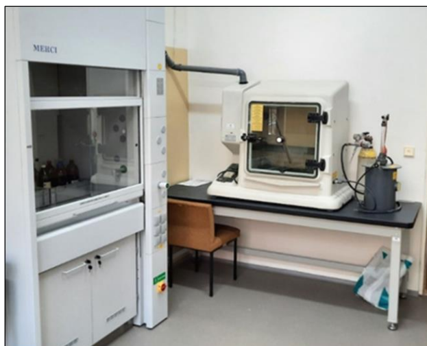
Obr. 21: Zkušebna klimatické a korozní odolnosti – kondenzační komora s SO 2 .
