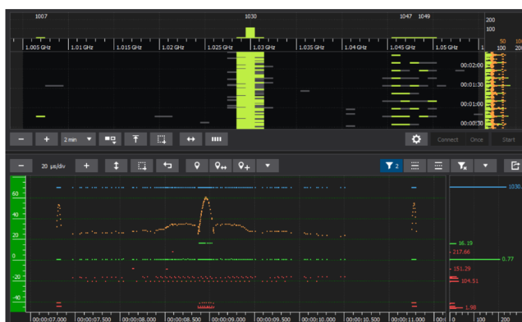
Obr. 7: Vzhled aplikačního vybavení analyzátoru radiotechnických cílů – RATAN
