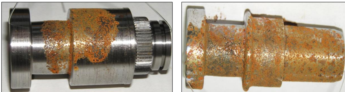
Obr. 20: Zkoušky klimatické a korozní odolnosti – strojní součásti po vystavení koroznímu prostředí kondenzační komory.
