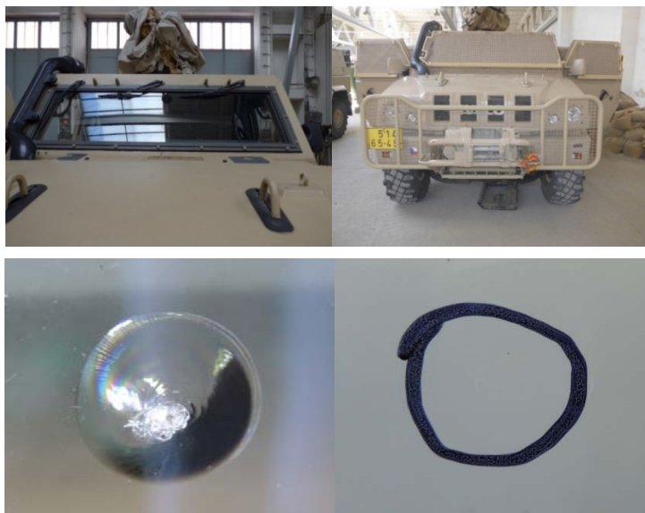
Pancéřové sklo poškozené ve tvaru oka.
