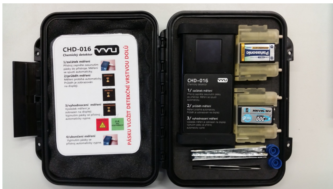
Vysoce citlivý osobní detektor BChL na bázi inhibitorů cholinesterázy CHD - 016
