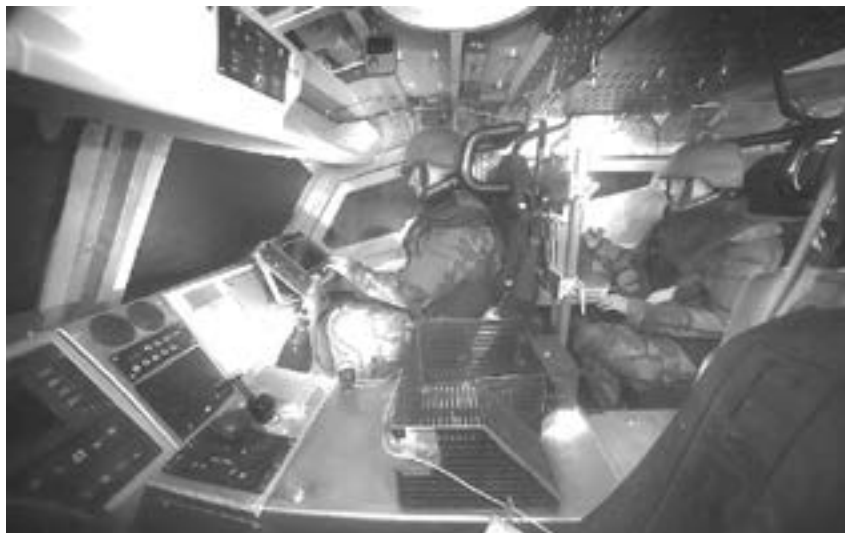
Prostor osádky vozidla Patriot 2 se dvěma figurínami Hybrid III
