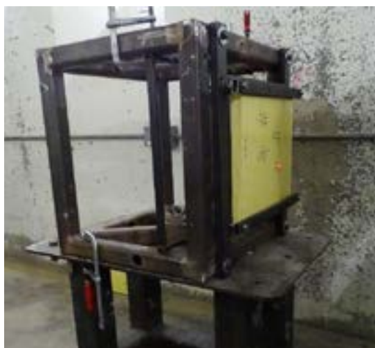
Střelecké zkoušky netransparentních pancéřových systémů
