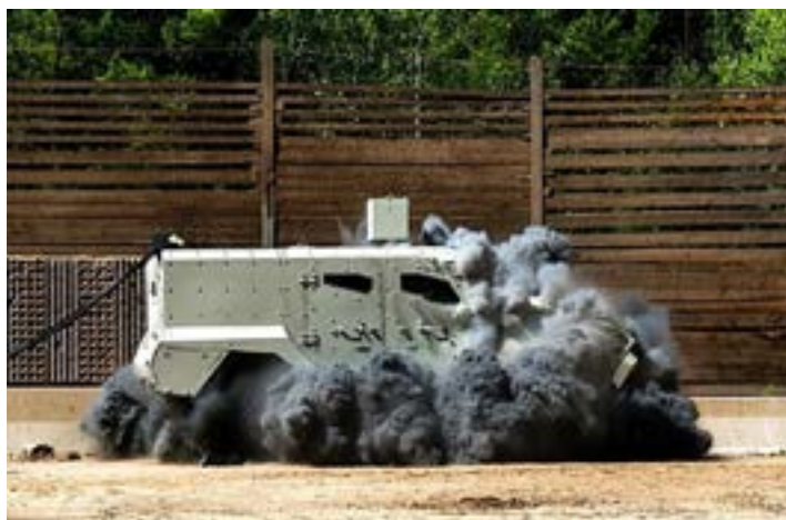
Zkouška protiminové ochrany vozidla Patriot 2 vyráběného společností Excalibur Army (CSG)
