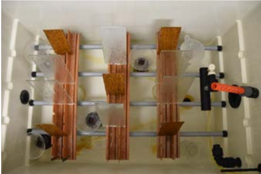
Zkušebna klimatické a korozní odolnosti – komora SO2
