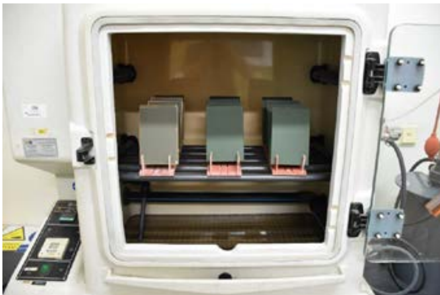
Zkušebna klimatické a korozní odolnosti – homogenita a agresivita solné mlhy
