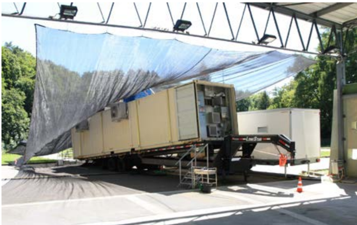
Zkušební komora pro testování dálkových detektorů v elevaci pro měření proti obloze.
