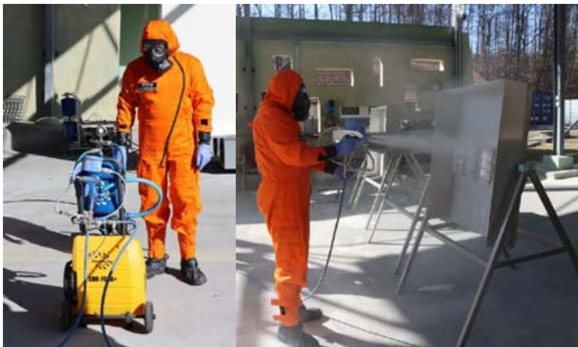
Validační zkoušky aplikátoru reaktivních sorbentů pro evropský projekt ST BERNARD.
